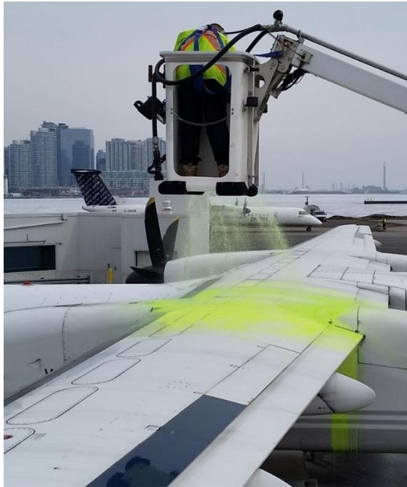
Une couverture adéquate et uniforme doit être garantie en appliquant une quantité suffisante pour éliminer complètement tout fluide de Type I restant sur les surfaces de l'aéronef. Les surfaces de l'aéronef doivent être recouvertes d'une profondeur de 1 à 3 millimètres. Une application insuffisante entraînera une couche mince et une réduction des performances d'efficacité du fluide.
